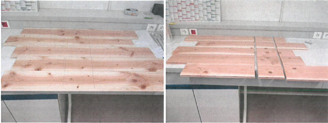
Photo 7 : Position de l'éprouvette d'essai dans les échantillons 14/1216C/1 (gauche) et 14/1216C/2 (droite)
